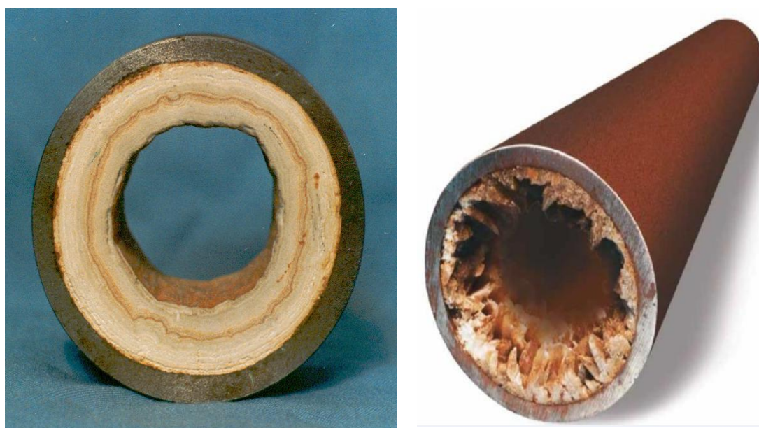
Рисунок 5 - Отложения солей в трубах НКТ и эксплуатационных колоннах
